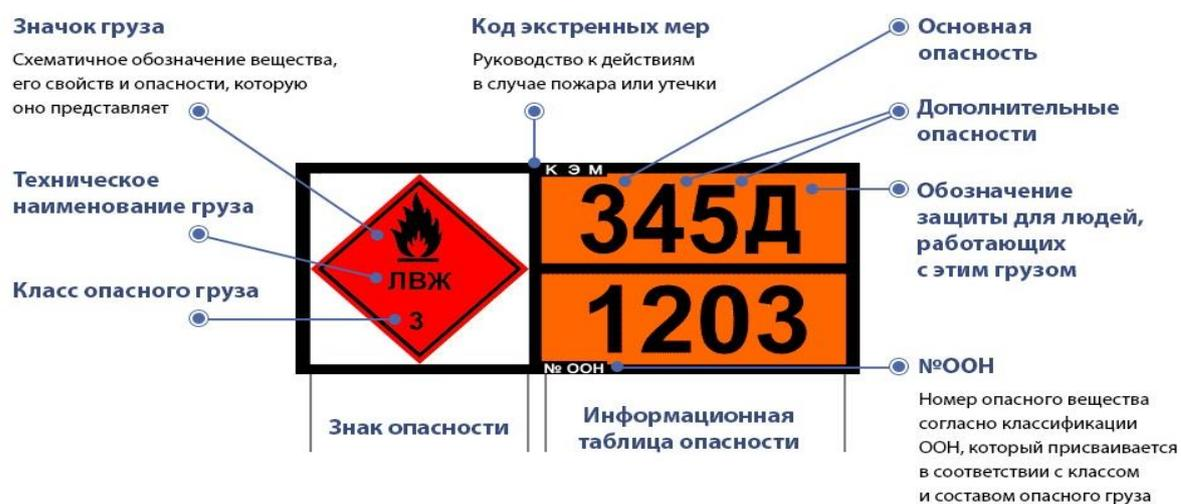
Рисунок 5. Информационная табличка для перевозки опасного груза
