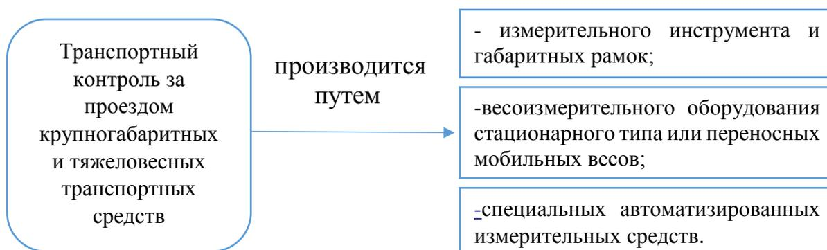
Рисунок 8. Транспортный контроль за проездом крупногабаритных и тяжеловесных транспортных средств путем проверки фактических весовых и габаритных параметров транспортных средств и определения величины их превышения над допустимыми параметрами
