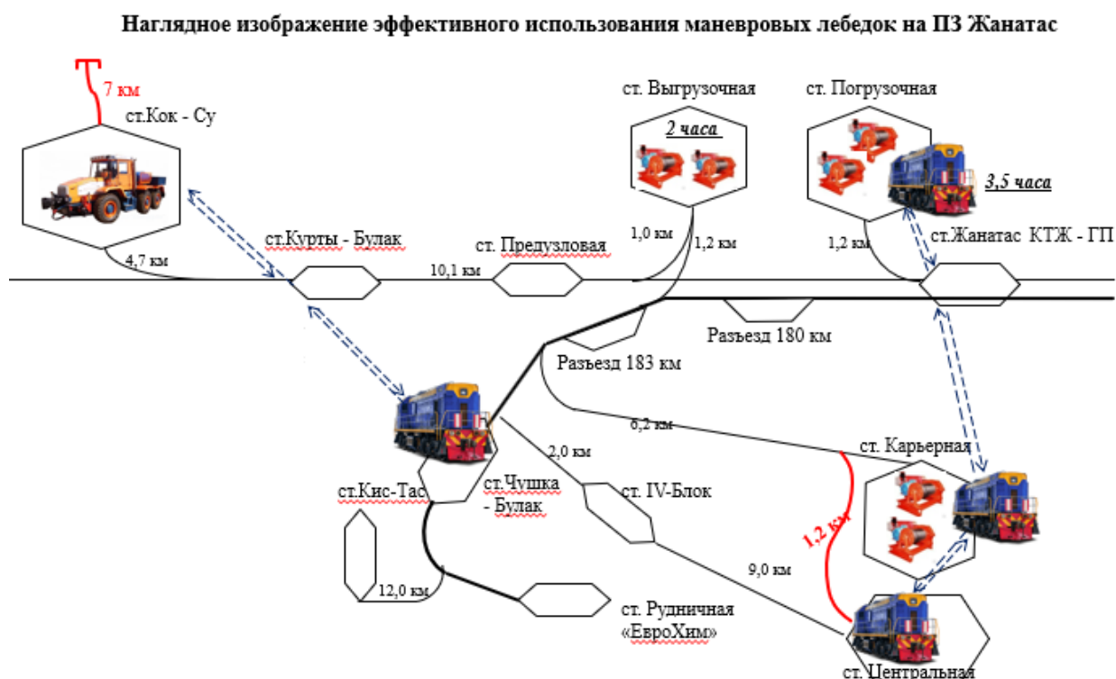
Рисунок 1.6 – Использование маневровых лебедок на ПЗ Жанатас
