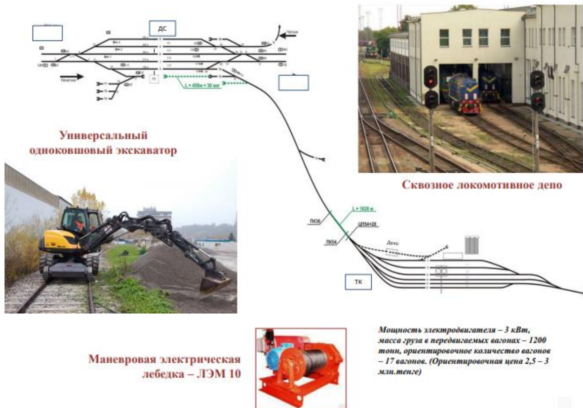
Рисунок 1.7 Использование маневровых лебедок на ст.Мын-Арал
